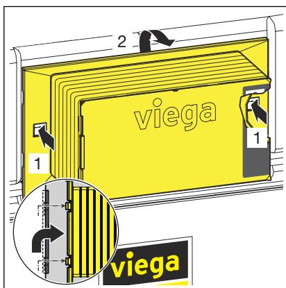
**i** Pour retirer à nouveau la trappe d'accès, enfoncez les clips de fixation latéraux.
