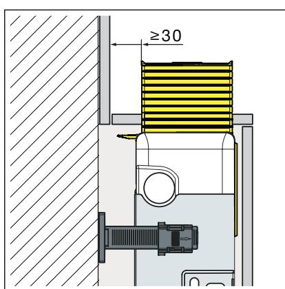
► En cas d'actionnement par le haut, respecter un écart minimal de 30 mm entre le bord avant du carrelage et la gaine.
