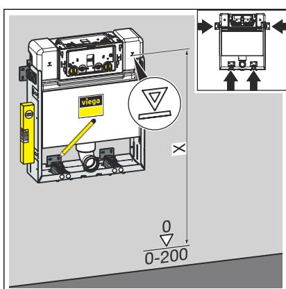
► Régler la hauteur de construction du bloc WC d'après l'identification du bord supérieur du sol fini réalisé sur place.
