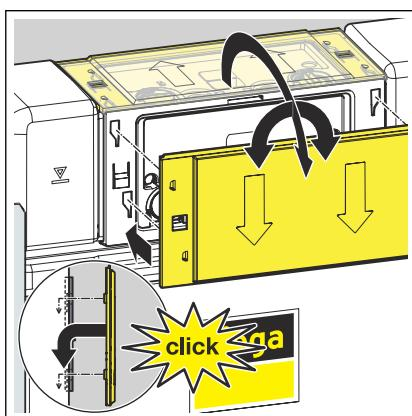
► Retirer le cache de montage et l'installer à l'avant.
