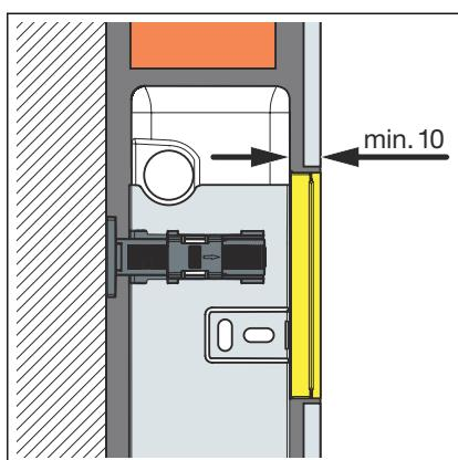
► La pose du carrelage doit présenter une épaisseur d'au moins 10 mm.
