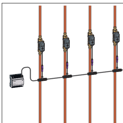
Abb. 5: AquaVip-Netzteil und x AquaVip-Zirkulationsreguliertventile, Spannungsversorgung mit AquaVip-T-Verbindern
